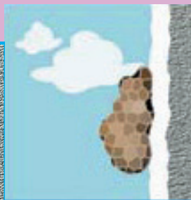
Onder invloed van zonlicht worden nano-gestructureerde speciale vulstoffen in de verf geactiveerd. De microvuildeeltjes verliezen door de Lucite-nanotechnologie en fotokatalyse hun hechting aan het oppervlak en lossen op.
